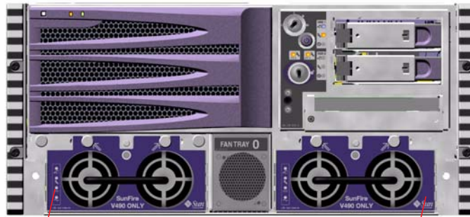
Emplacement du bloc d'alimentation 0 Emplacement du bloc d'alimentation 1
