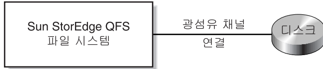
그림 1-1 Sun StorEdge QFS 단일 Solaris 호스트 구성
