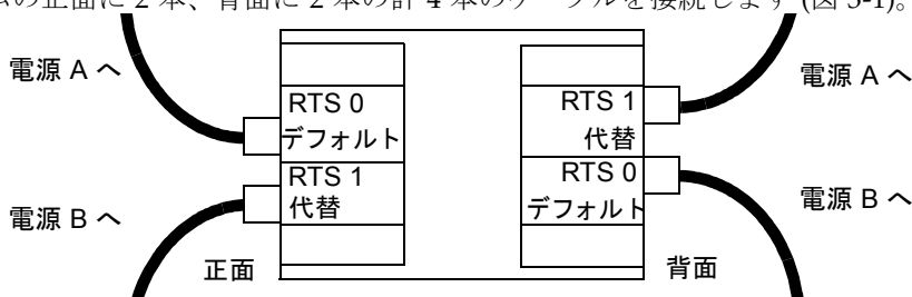
図 3-1 2 つの RTU アセンブリおよび 2 つの独立した AC 電源での構成
