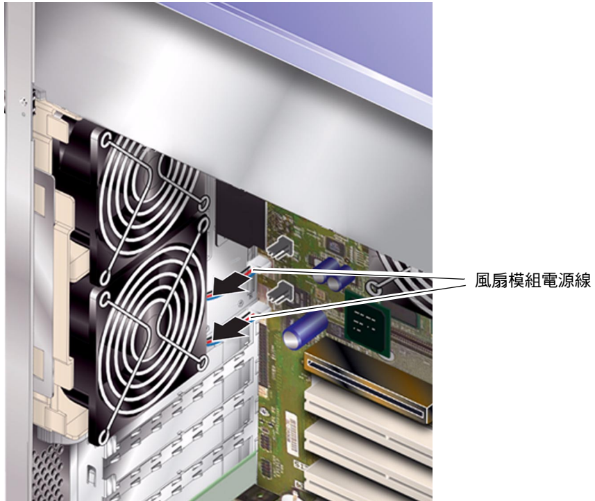
圖 1-17 拔下風扇模組的電源線
