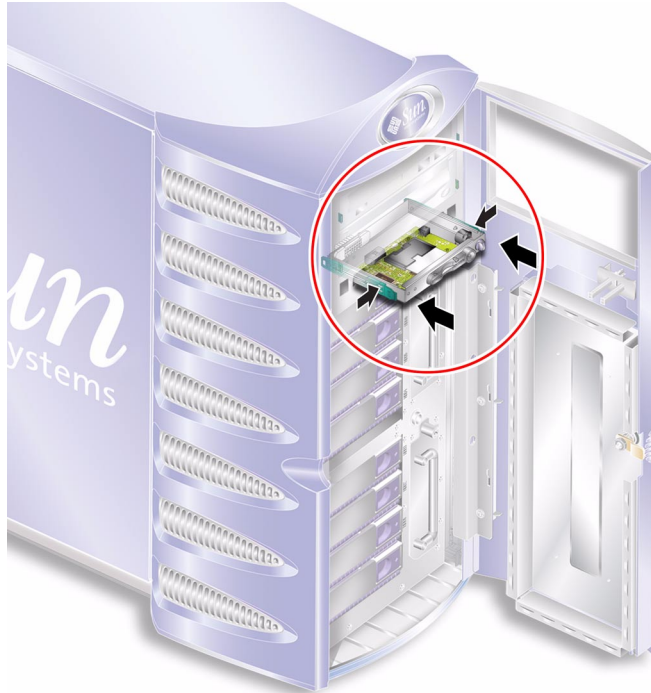
圖 1-11 更換系統組態卡讀取器模組
