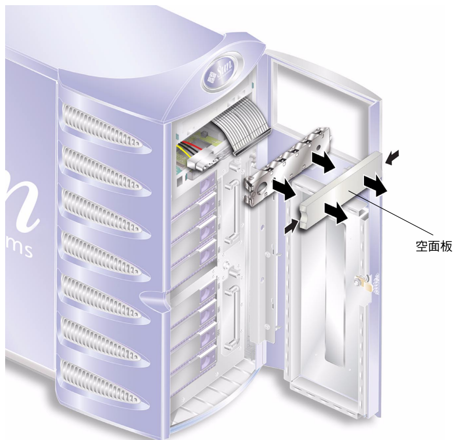
圖 1-27 移除磁帶機空面板
