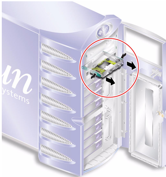
圖 1-10 移除系統組態卡讀取器模組
