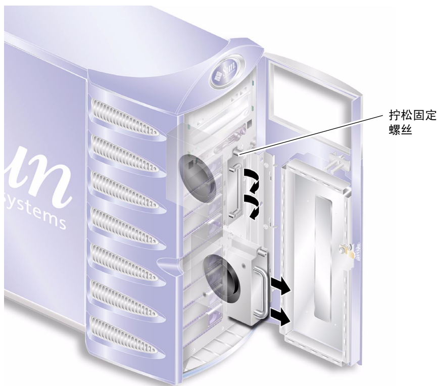
图 1-32 拆卸前部风扇模块
