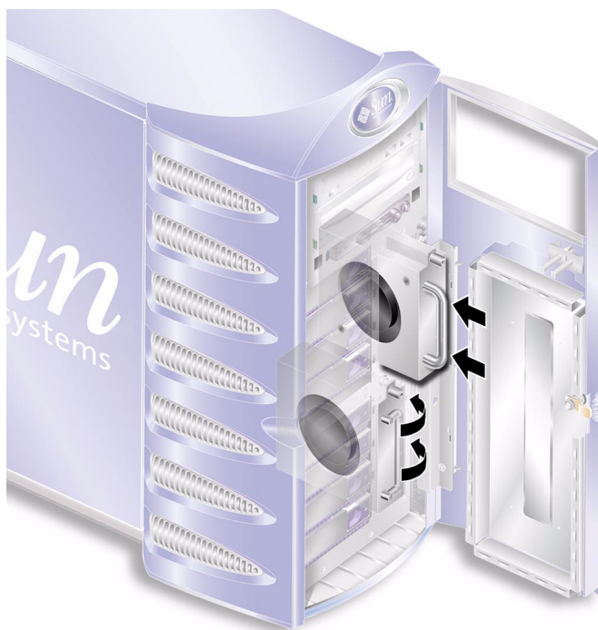
図 1-33 正面ファンモジュールの取り付け
