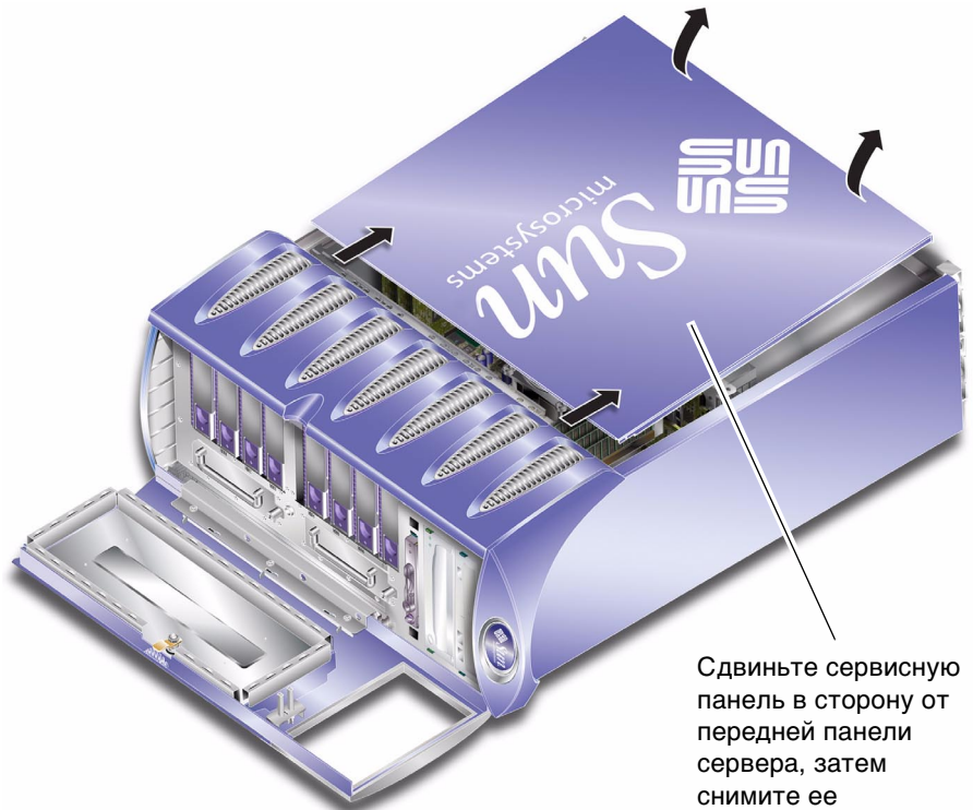
РИС. 1-4 Снятие сервисной панели
