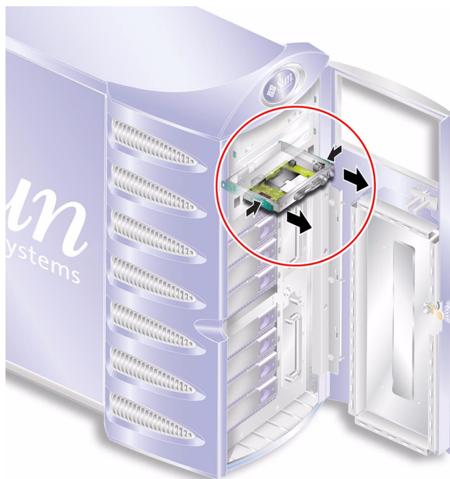
РИС. 1-10 Извлечение модуля считывающего устройства для карты конфигурации системы
