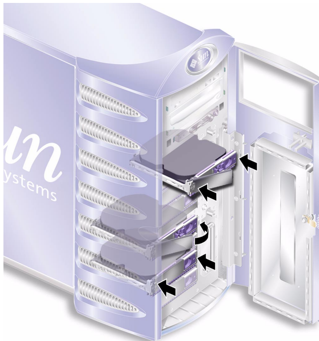
РИС. 1-7 Установка накопителя на жестких дисках
