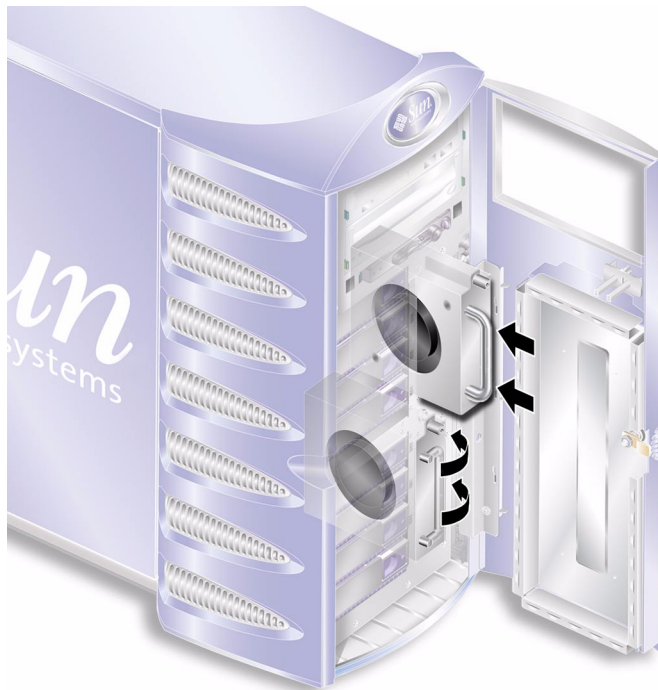
FIGURA 1-33 Reemplazo de un módulo frontal de ventilador
