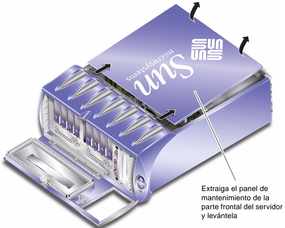
FIGURA 1-4 Extracción del panel de mantenimiento
