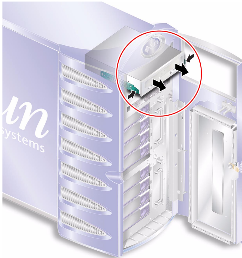
FIGURA 1-30 Extracción de la unidad de DVD-ROM
