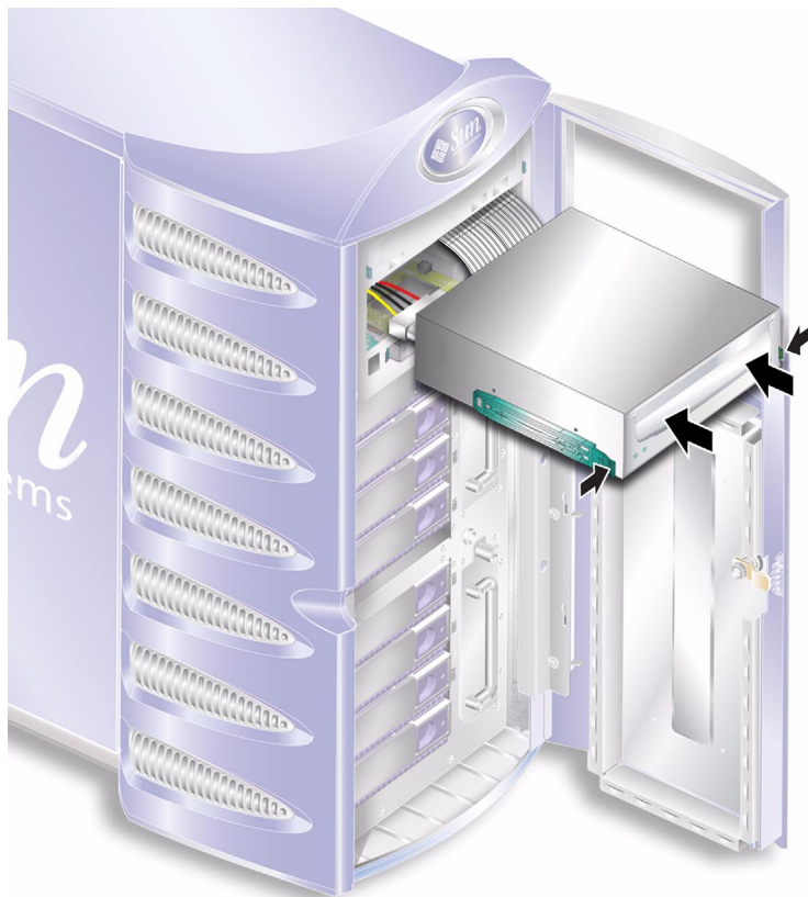
FIGURA 1-28 Installazione di un modulo dell'unità nastro
