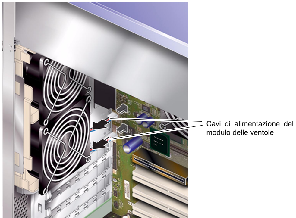
FIGURA 1-17 Scollegamento dei cavi di alimentazione del modulo delle ventole
