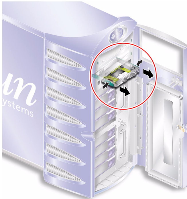
FIGURA 1-10 Rimozione del modulo del lettore della scheda di configurazione del sistema
