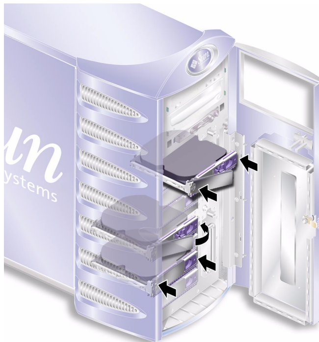
FIGURA 1-7 Inserimento di un'unità disco rigido
