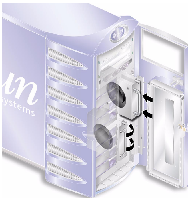
FIGURA 1-33 Sostituzione di un modulo della ventola anteriore
