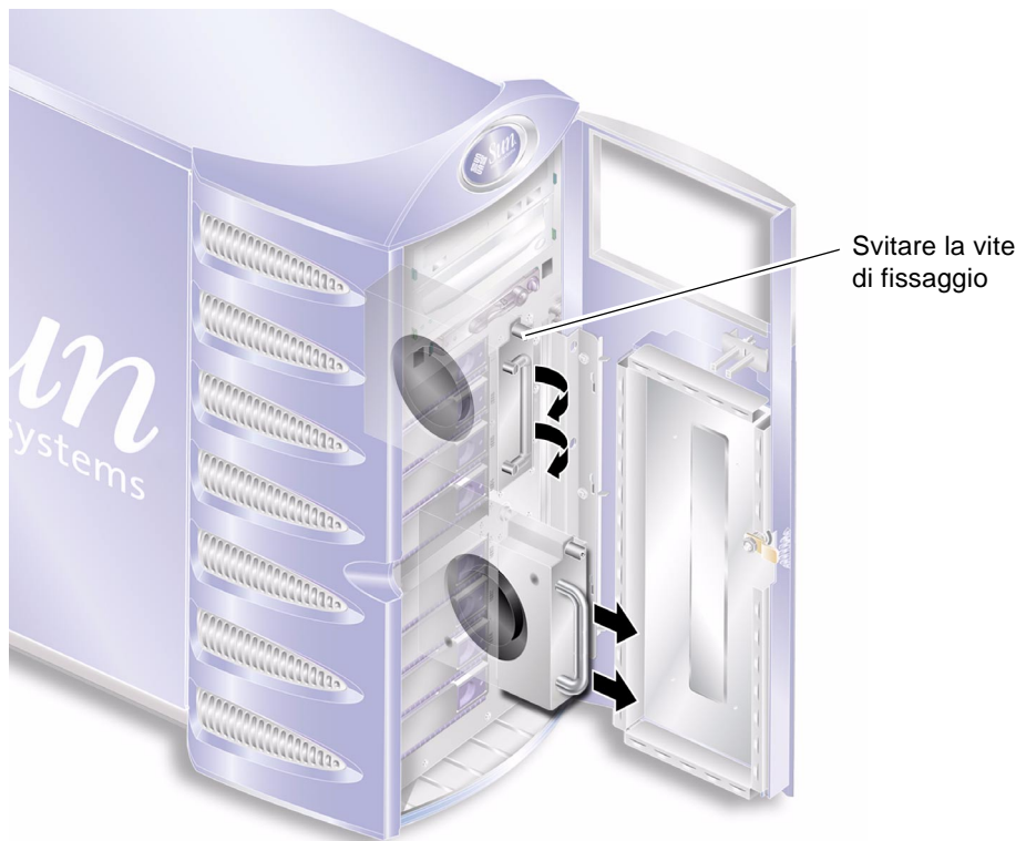
FIGURA 1-32 Rimozione del modulo della ventola anteriore
