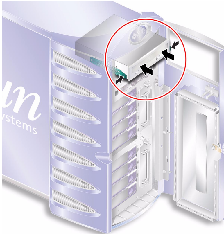
ABBILDUNG 1-31 Austauschen eines DVD-ROM-Laufwerk
