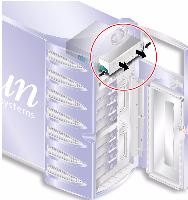
ABBILDUNG 1-30 Entfernen des DVD-ROM-Laufwerks
