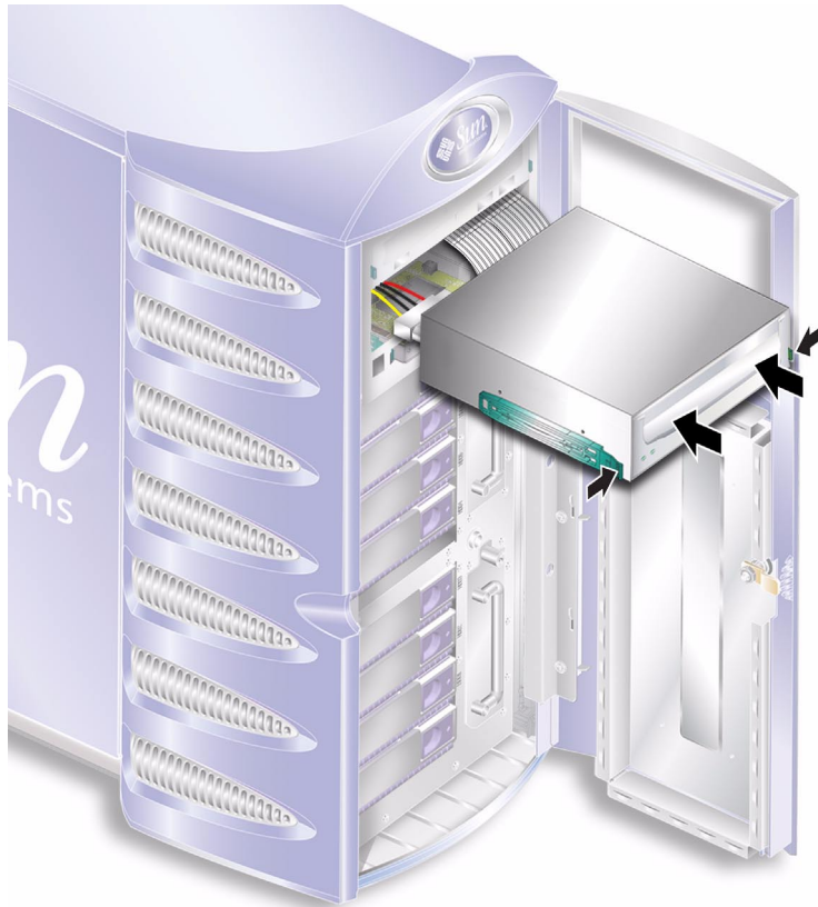
ABBILDUNG 1-28 Installieren eines Bandlaufwerks
