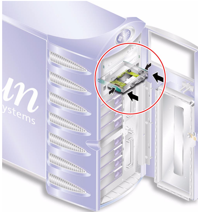
ABBILDUNG 1-11 Austauschen des Lesegeräts für die Systemkonfigurationskarte
