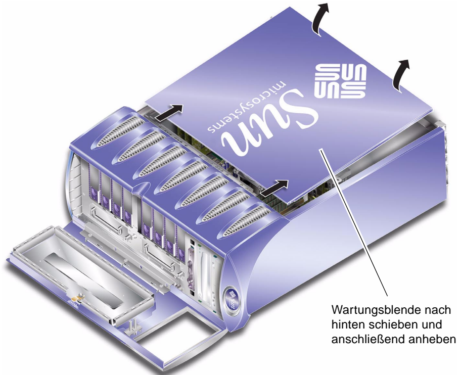
ABBILDUNG 1-4 Entfernen der Wartungsblende
