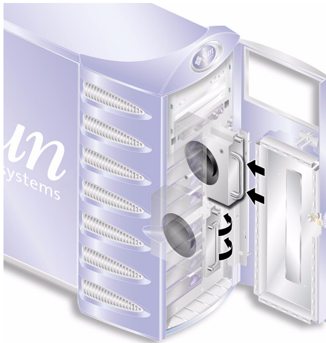
ABBILDUNG 1-33 Austausch der vorderen Lüftereinheit
