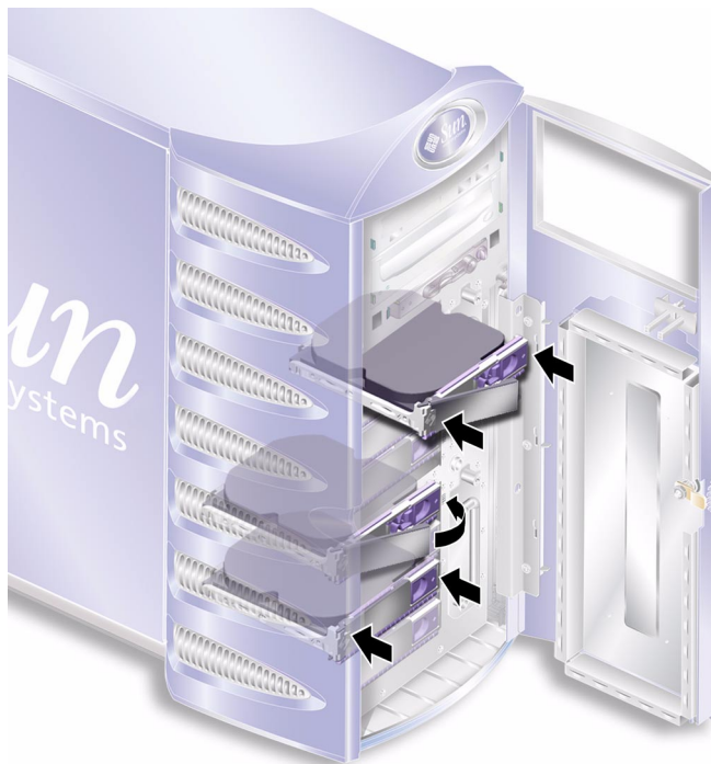
ABBILDUNG 1-7 Einbau eines Festplattenlaufwerks
