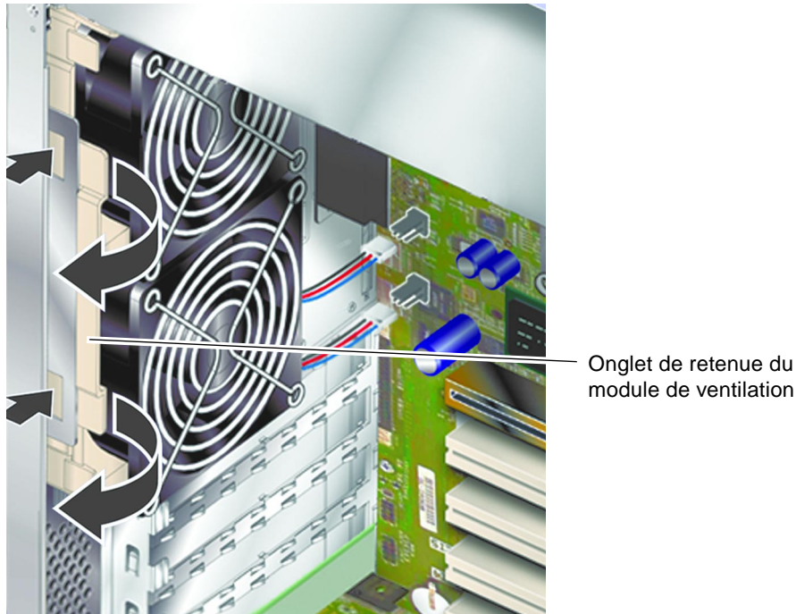
FIGURE 1-18 Retrait du module de ventilation
