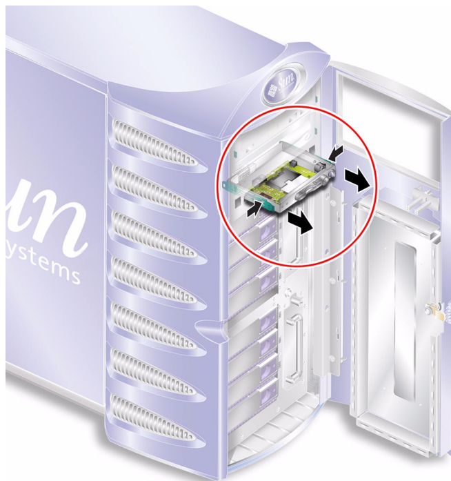
FIGURE 1-10 Retrait du module de lecture de la carte de configuration système
