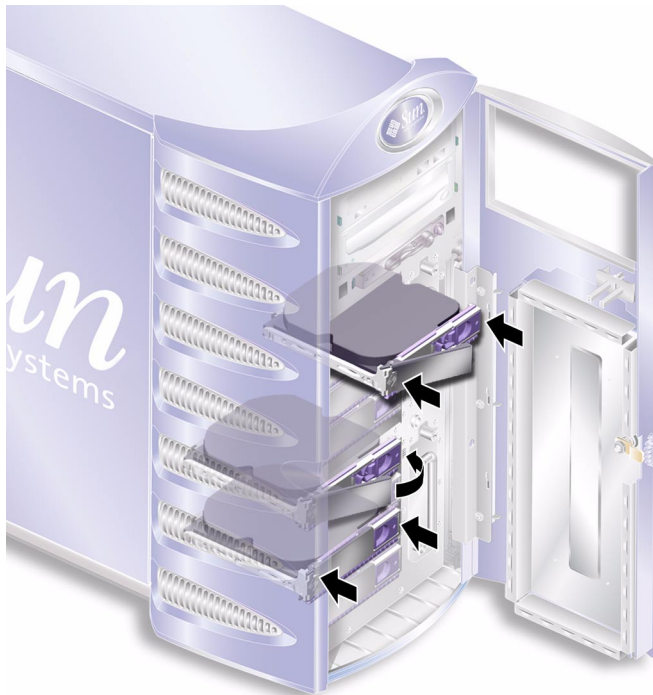
FIGURE 1-7 Insertion d'un disque dur
