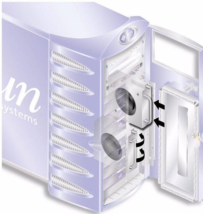
FIGURE 1-33 Réinsertion d'un module de ventilation avant
