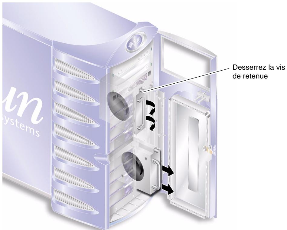
FIGURE 1-32 Retrait du module de ventilation avant
