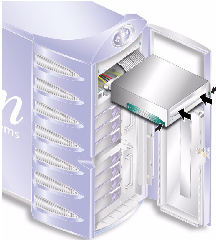
FIGURE 1-28 Installation d'un module de lecteur de bande magnétique
