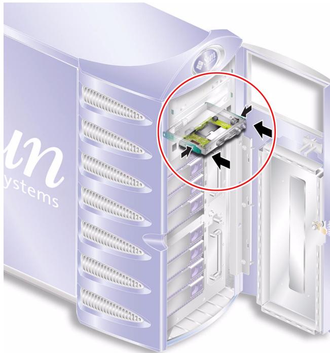
FIGURE 1-11 Remplacement du module de lecture de la carte de configuration système
