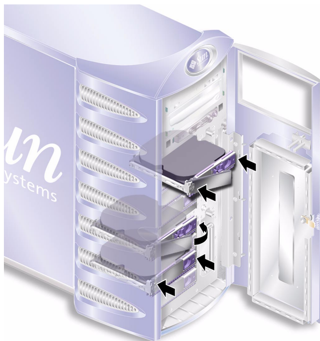
図 2-3 ハードディスクドライブの挿入
