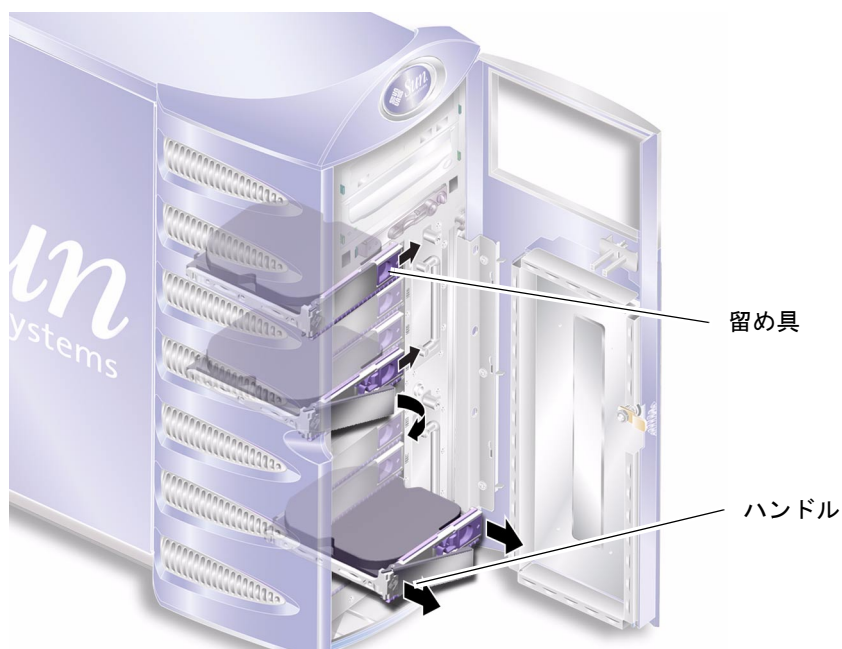
図 2-2 ハードディスクドライブの取り外し
