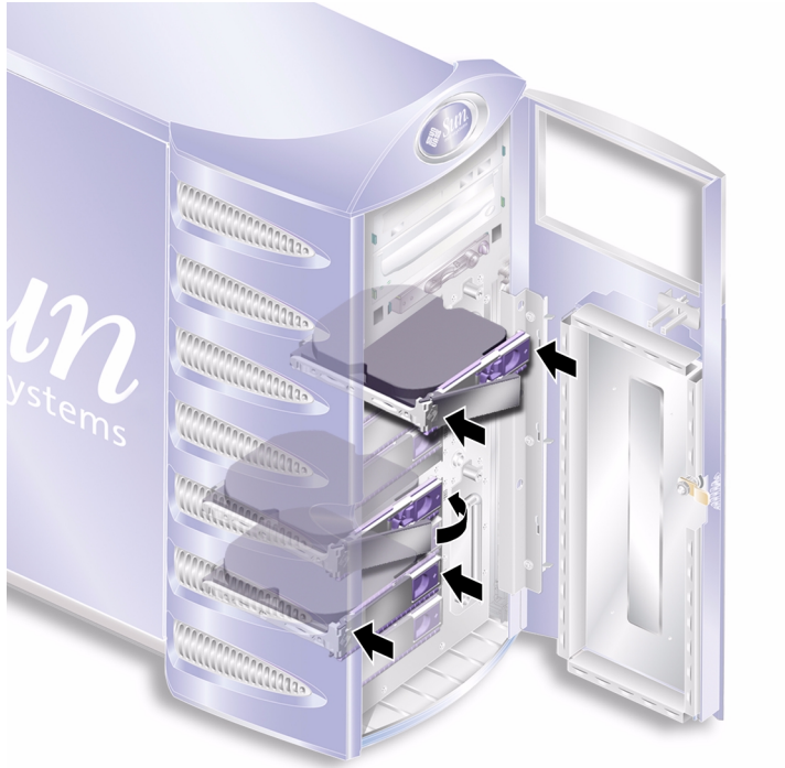
FIGURA 2-3 Colocación de una unidad de disco duro
