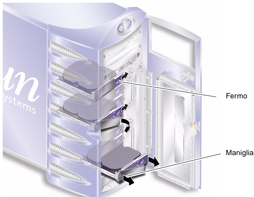
FIGURA 2-2 Rimozione di un disco rigido
