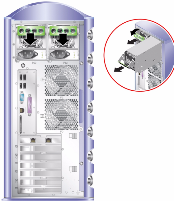
ABBILDUNG 2-4 Ausbau einer Stromversorgungseinheit
