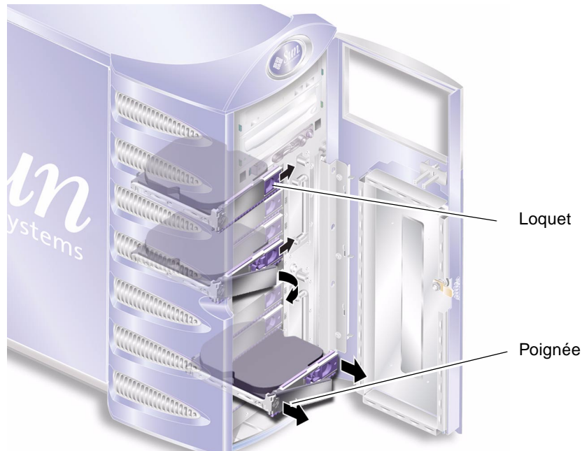
FIGURE 2-2 Retrait d'un disque dur
