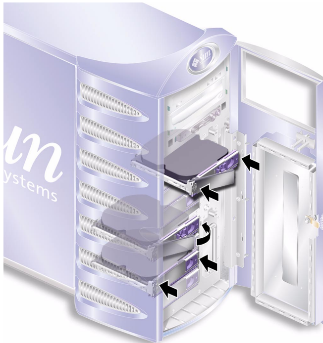
FIGURE 2-3 Insertion d'un disque dur
