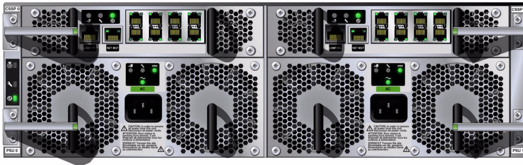
図 5-7 Sun Fire B1600 システムシャーシ (背面)
