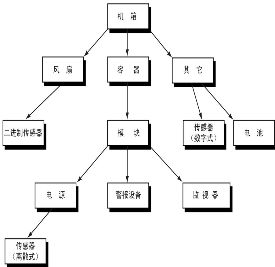
图 4-1 硬件资源分层结构示例
