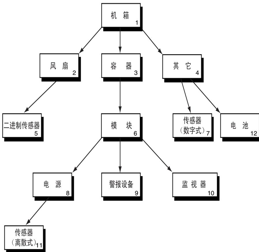
图 5-1 硬件资源分层结构示例
