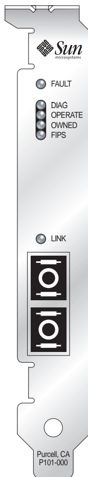
FIGURE A-1 Crypto Accelerator 4000 de Sun Connecteur de l'adaptateur MMF
