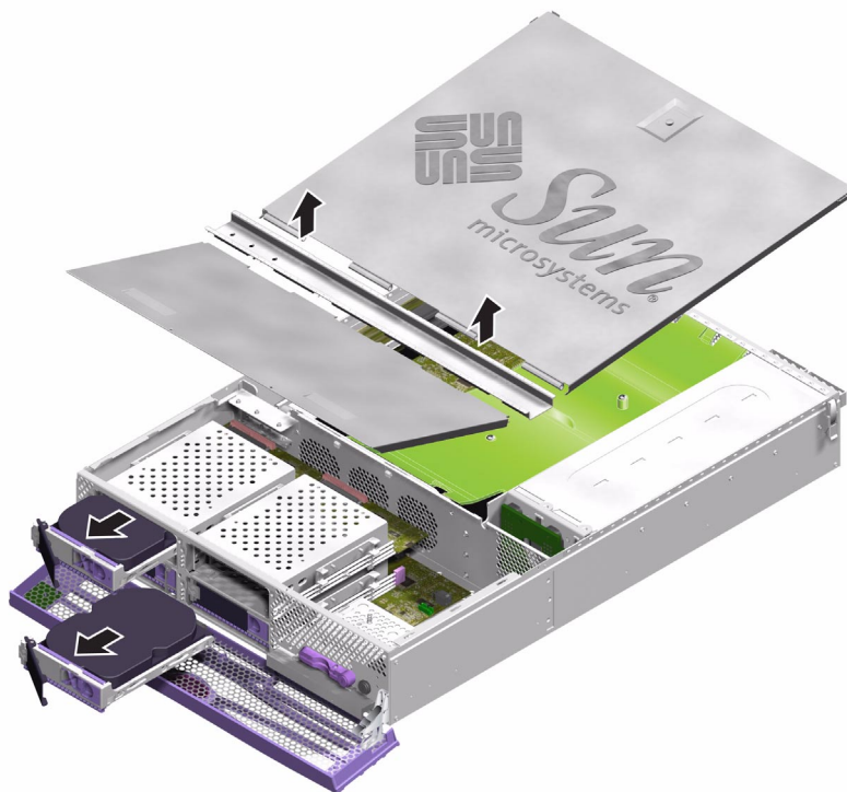
圖 1-22 卸下護蓋組件與硬碟機以取出介面卡
