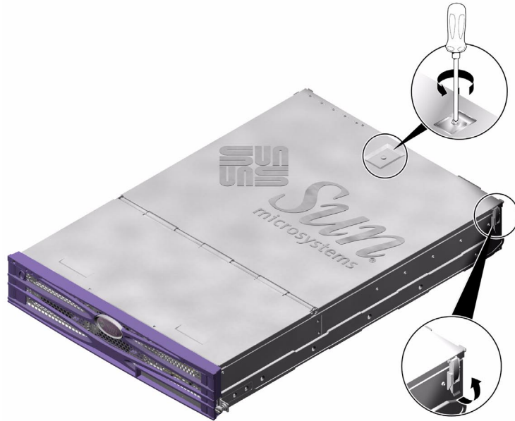
圖 1-4 護蓋背面部分的固定螺絲與側面掣子位置
