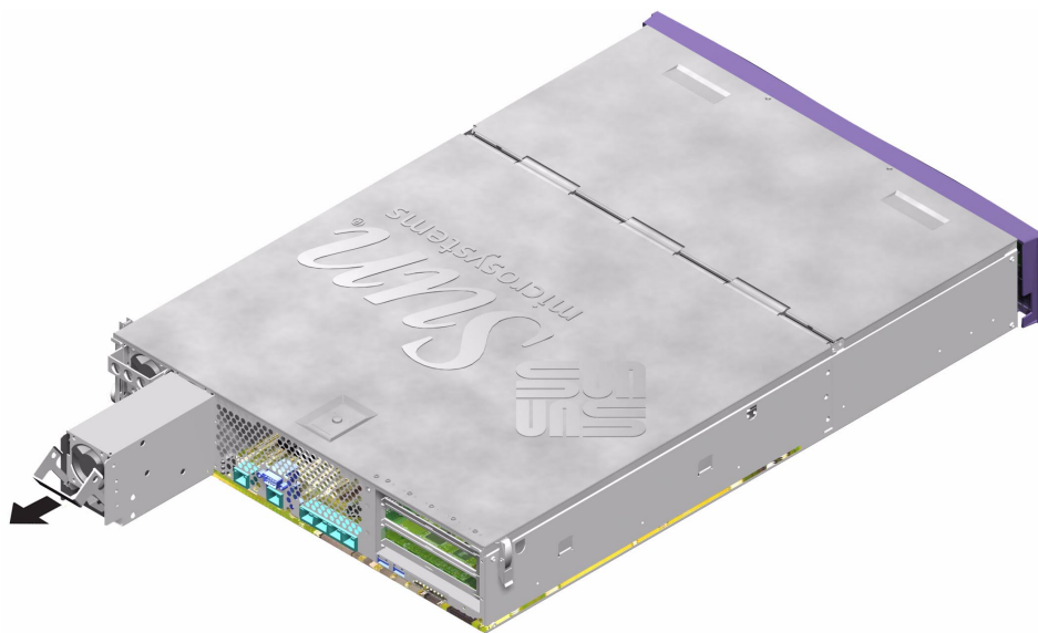
圖 1-13 卸下 Sun Fire V240 伺服器中的 PSU
