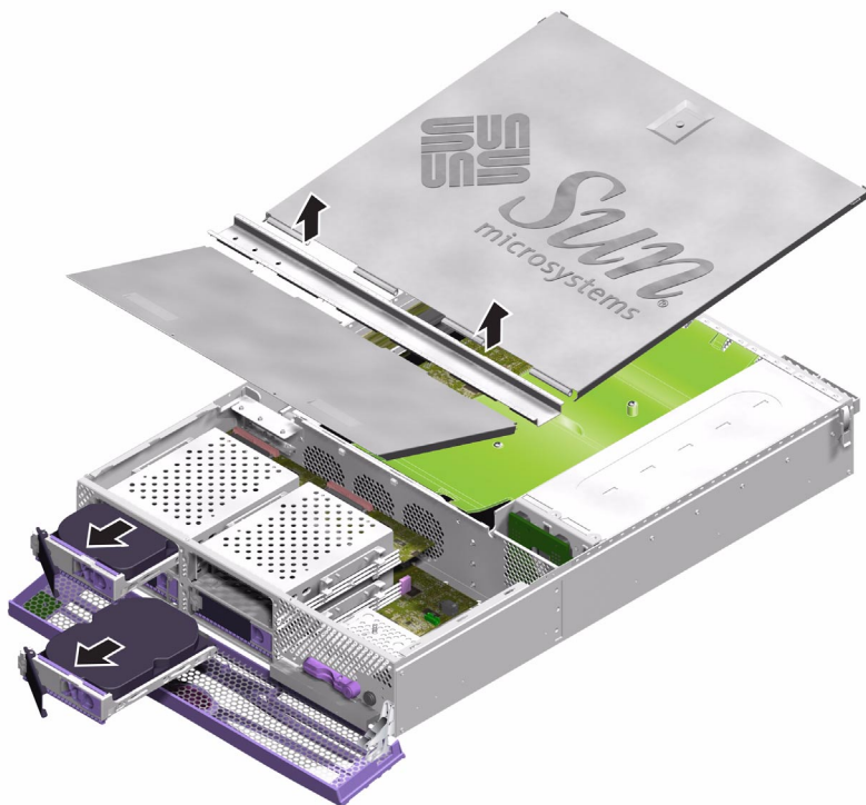
图 1-22 卸下盖板部件和硬盘驱动器以拆卸接口板
