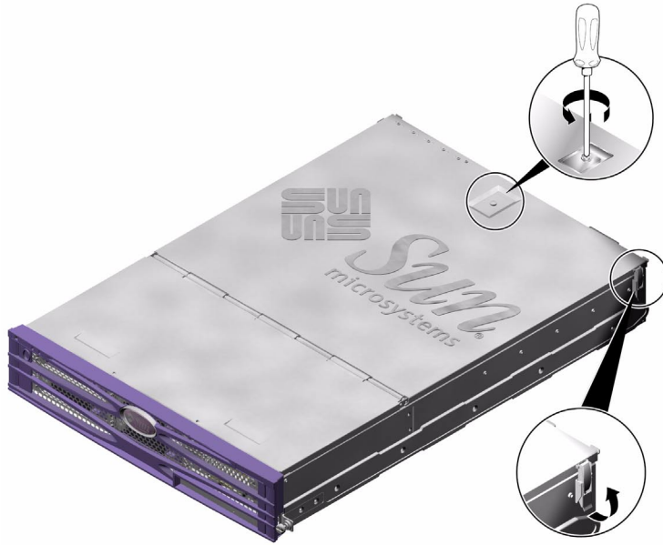
图 1-4 后部盖板上栓系螺丝和侧面卡锁的位置
