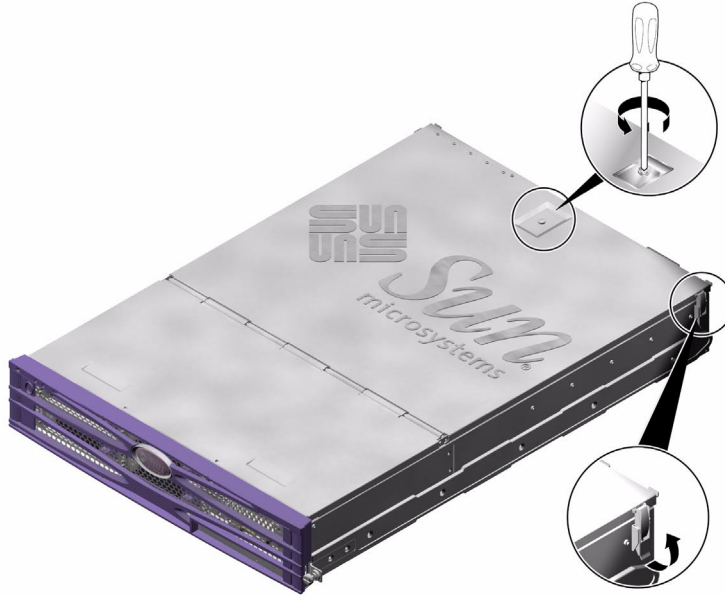
그림 1-4 덮개 뒤쪽의 조임 나사 및 측면 잠금쇠의 위치
