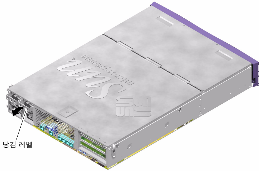
그림 1-12 Sun Fire V240 서버의 전원 공급 장치 레버
