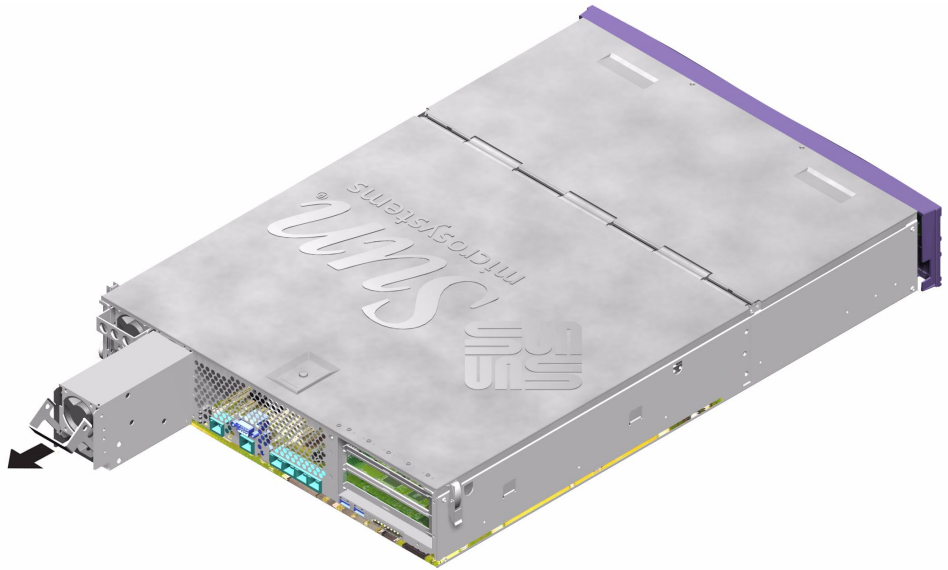
그림 1-13 Sun Fire V240 서버에서 PSU 분리
