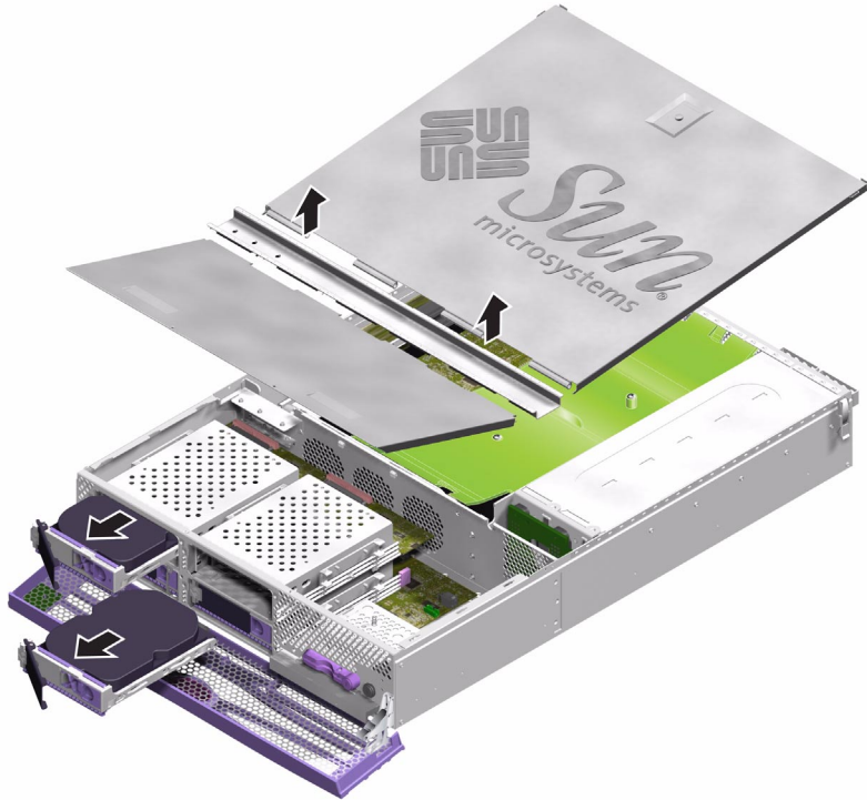
그림 1-22 인터페이스 보드에 접근하기 위한 덮개 어셈블리 및 하드 디스크 드라이브 제거
