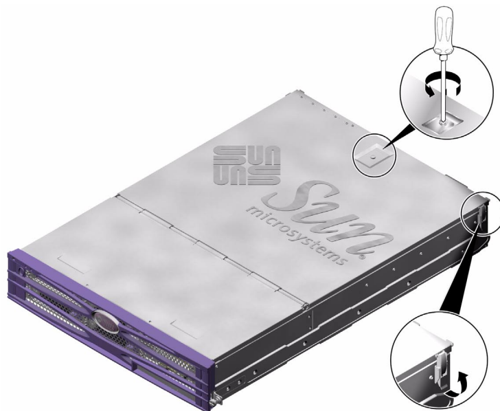
図 1-4 カバーの背面部分の脱落防止機構付きねじおよび側面の留め金の位置
