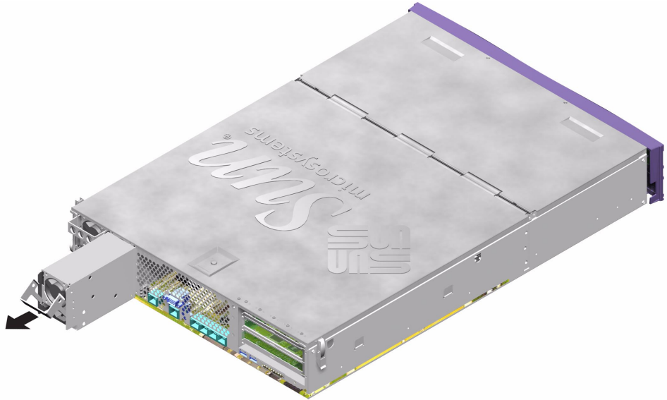
РИС. 1-13 Снятие блока питания на сервере Sun Fire V240
