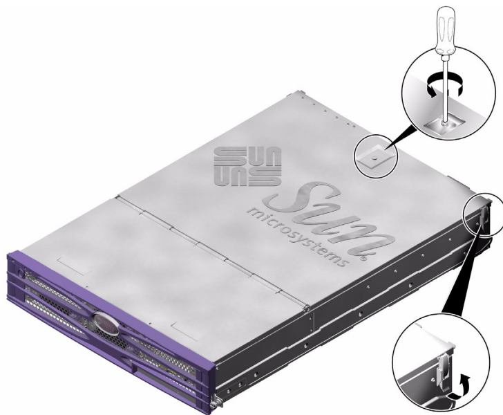
РИС. 1-4 Расположение невыпадающего винта и боковых фиксаторов на задней части крышки корпуса
