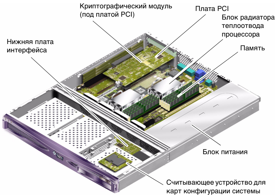
РИС. 1-7 Расположение основных компонентов сервера Sun Fire V210
