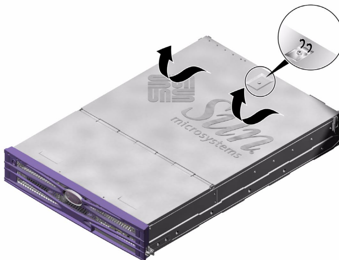
РИС. 1-5 Расположение защелки на задней части крышки
