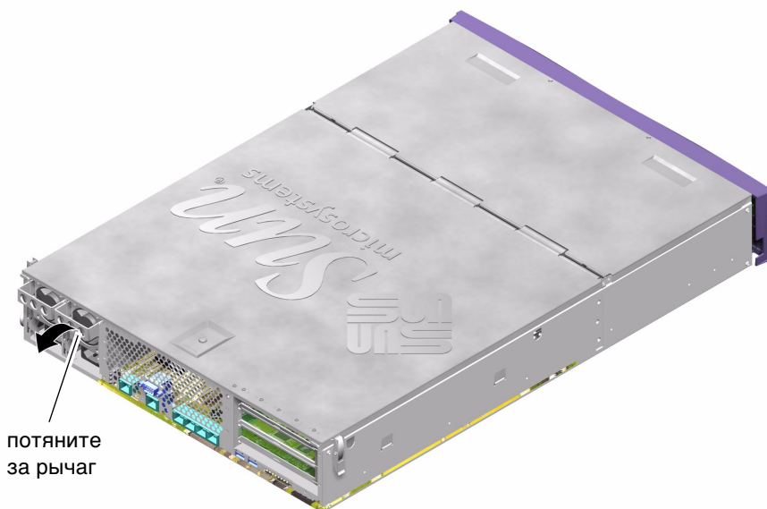
РИС. 1-12 Рычаг блока питания на сервере Sun Fire V240
