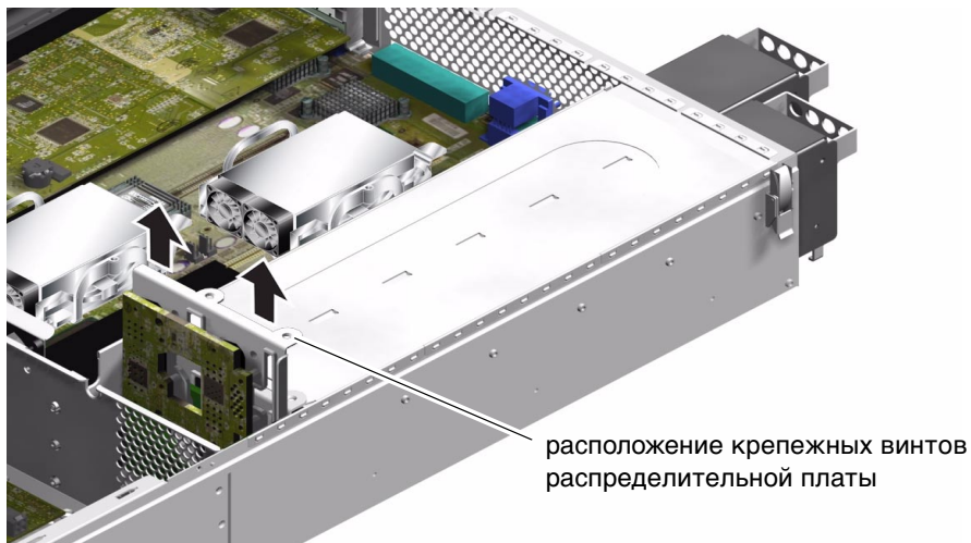
РИС. 1-15 Снятие распределительной платы (только Sun Fire V240)
