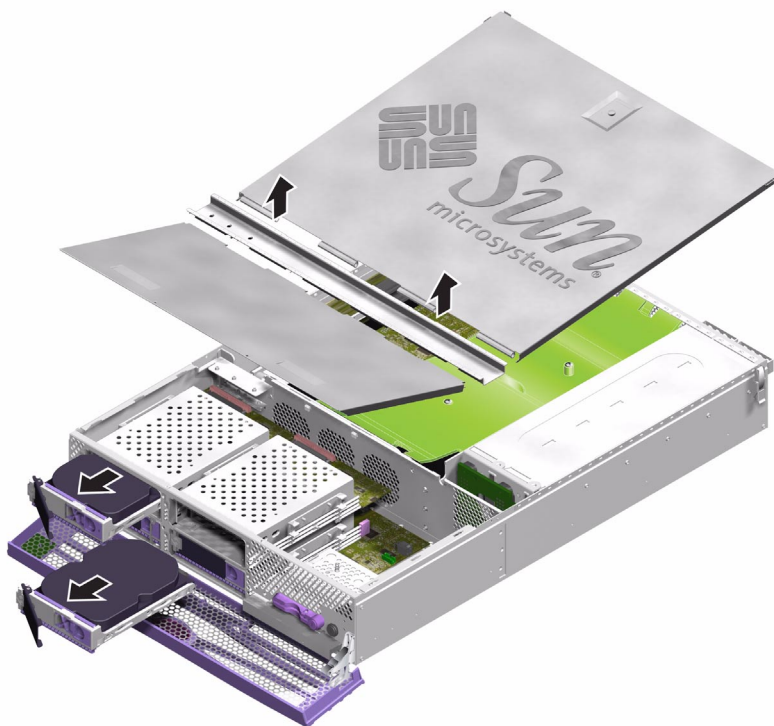
РИС. 1-22 Снятие крышки корпуса в сборе и накопителей на жестких дисках для доступа к платам интерфейса
