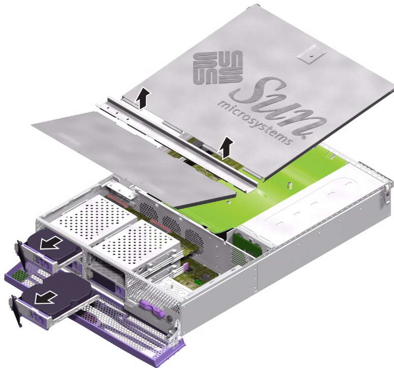
FIGURA 1-22 Extracción del ensamblaje de la cubierta y las unidades de disco duro para acceder a las tarjetas de interfaz
