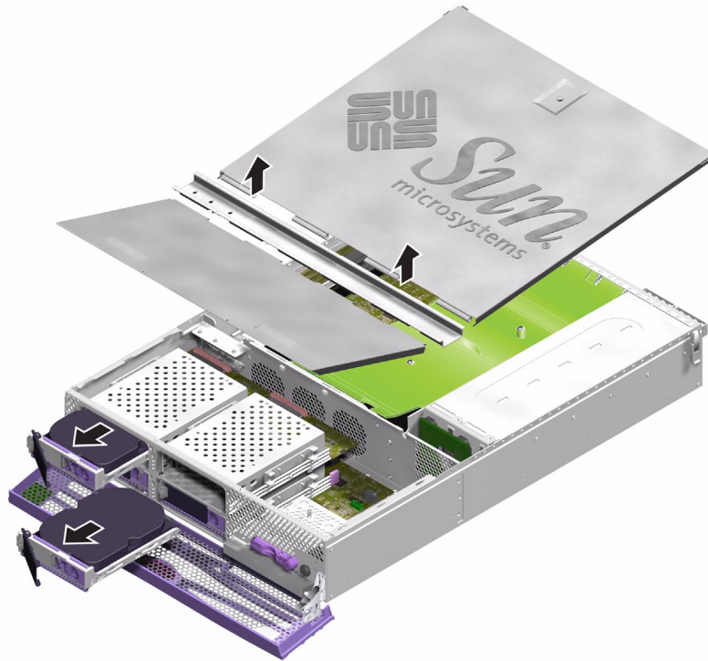
FIGURA 1-22 Rimozione del gruppo del coperchio e dei dischi rigidi per l'accesso alle schede di interfaccia
