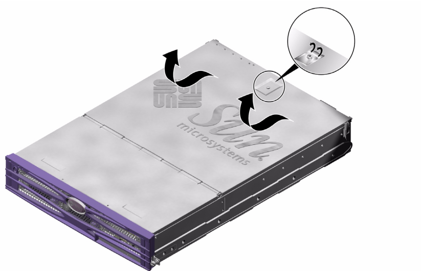
ABBILDUNG 1-5 Lage der Sperrvorrichtung am hinteren Teil der Gehäuseabdeckung
