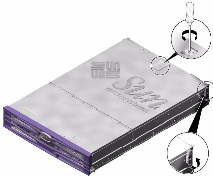
ABBILDUNG 1-4 Lage der unverlierbaren Schraube und der seitlichen Schnappverschlüsse am hinteren Teil der Abdeckung
