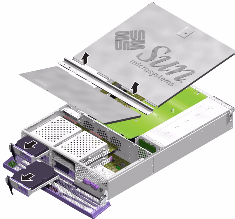
ABBILDUNG 1-22 Ausbauen der Abdeckung und der Festplattenlaufwerke für den Zugang zu den Schnittstellenkarten
