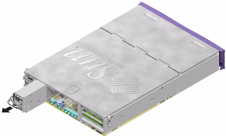
ABBILDUNG 1-13 Ausbau einer Stromversorgungseinheit beim Sun Fire V240
