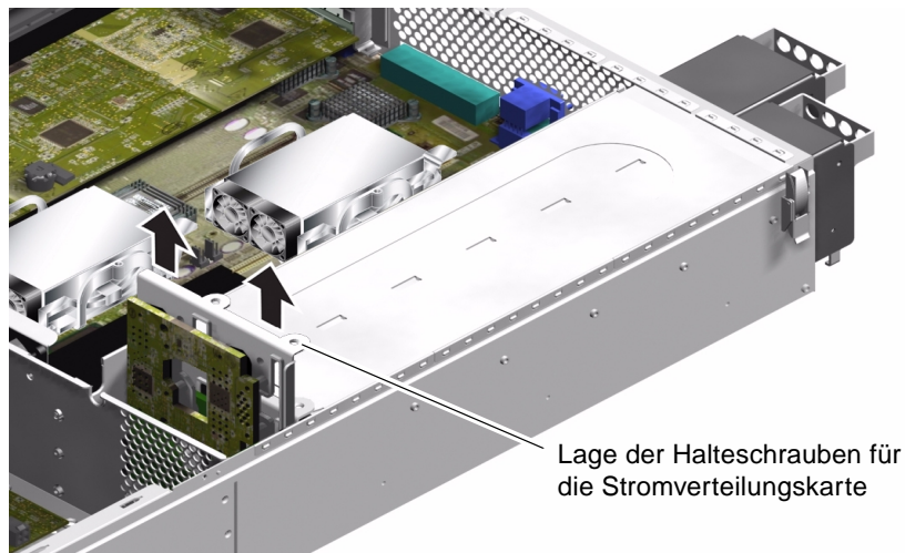
ABBILDUNG 1-15 Ausbauen der Stromverteilungskarte (nur beim Sun Fire V240)
