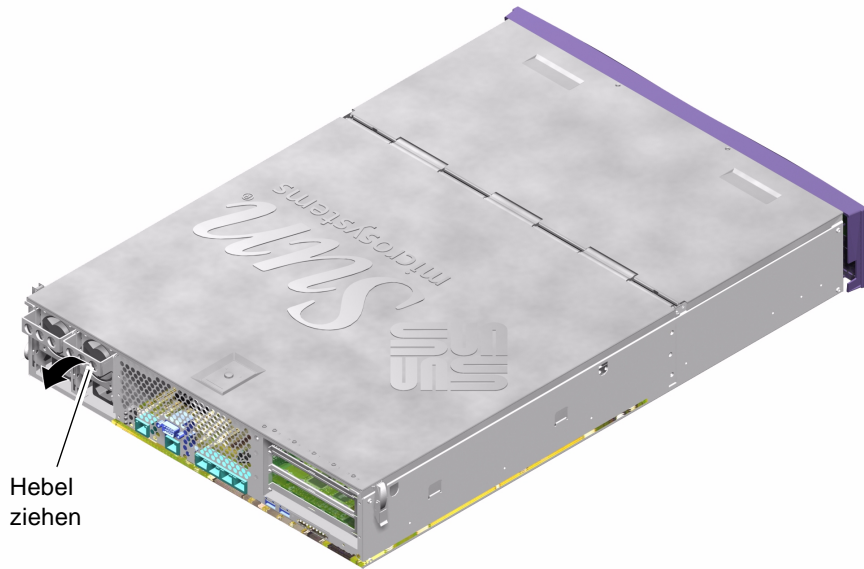
ABBILDUNG 1-12 Griffhebel der Stromversorgungseinheit am Sun Fire V240
