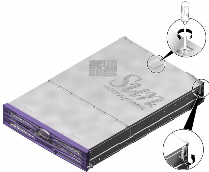
FIGURE 1-4 Emplacement de la vis captive et des systèmes de fermeture latéraux sur la section arrière du couvercle
