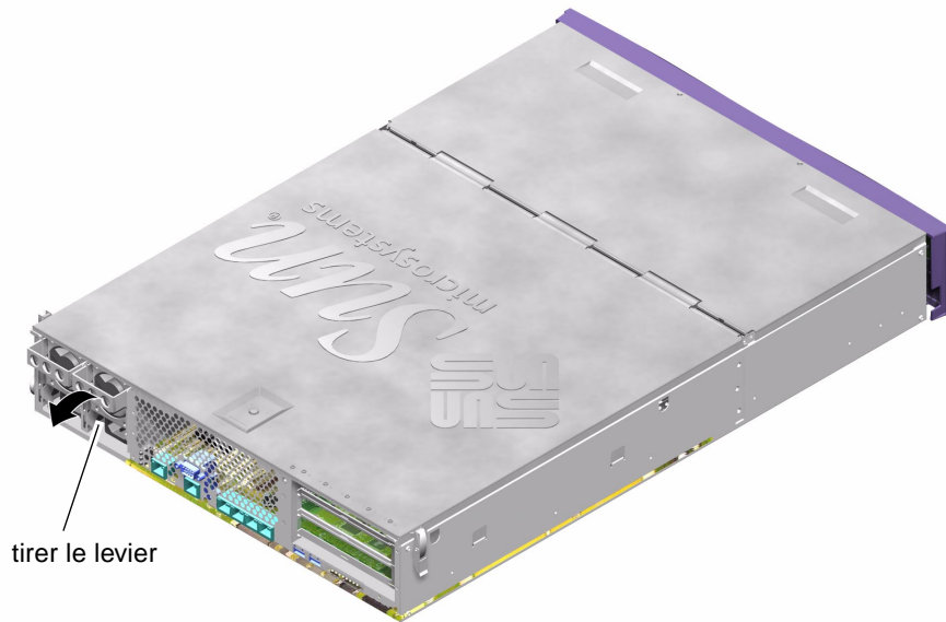
FIGURE 1-12 Levier de l'unité d'alimentation du serveur Sun Fire V240
