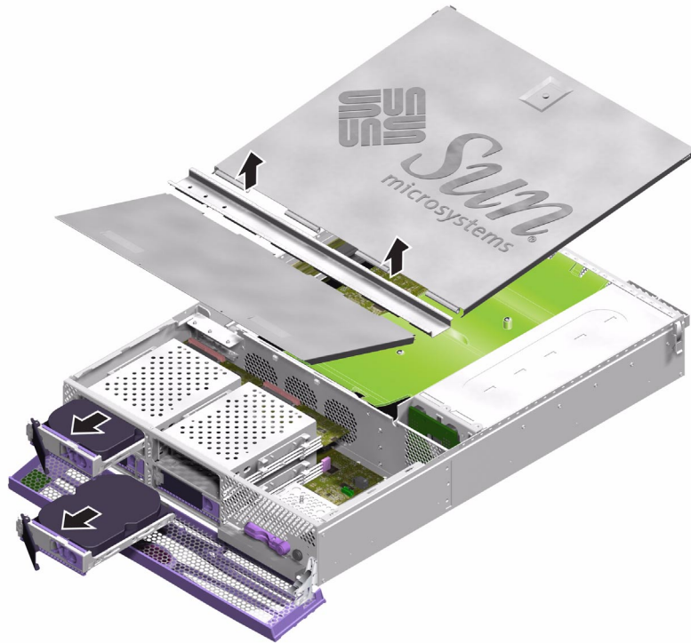
FIGURE 1-22 Retrait du couvercle et des disques durs en vue d'accéder aux cartes réseau
