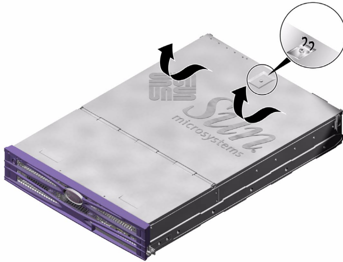
FIGURE 1-5 Emplacement du système de fermeture sur la section arrière du couvercle
