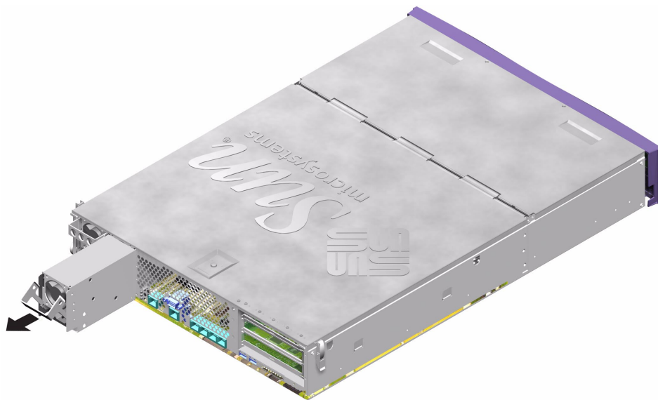
FIGURE 1-13 Retrait d'une unité d'alimentation du serveur Sun Fire V240
