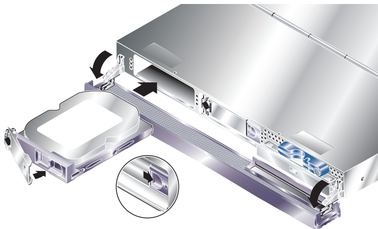
图 2-4 插入硬盘驱动器（Sun Fire V210 服务器示图）
