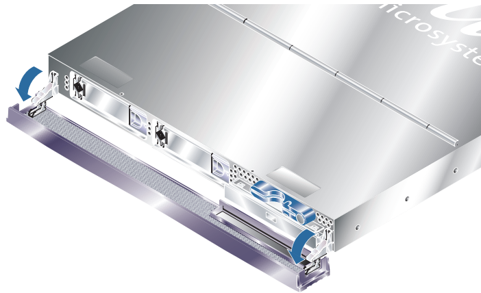
图 2-1 打开 Sun Fire V210 服务器的挡板
