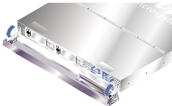
図 2-1 Sun Fire V210 サーバーのベゼルを開いた状態
