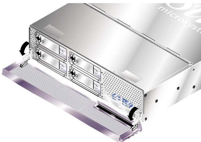
図 2-2 Sun Fire V240 サーバーのベゼルを開いた状態
