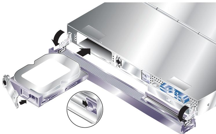
**FIGURA 2-4** Inserimento di un'unità disco rigido (server Sun Fire V210)
