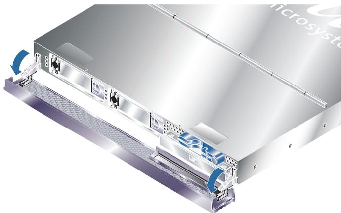
FIGURA 2-1 Apertura del frontalino di un server Sun Fire V210
