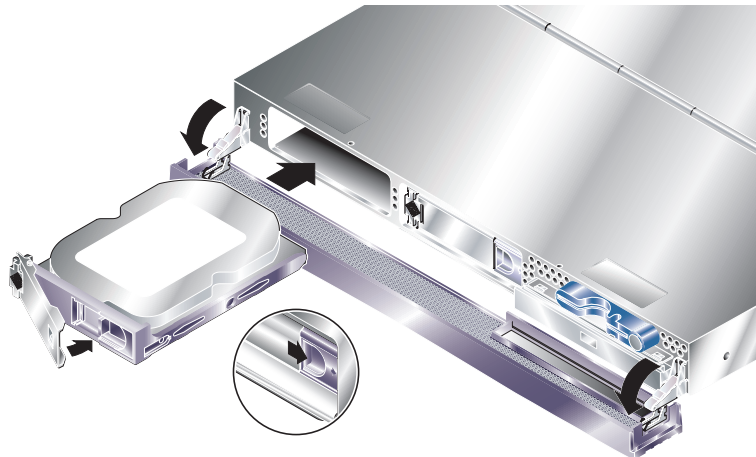
ABBILDUNG 2-4 Einbauen eines Festplattenlaufwerks (hier beim Sun Fire V210)
