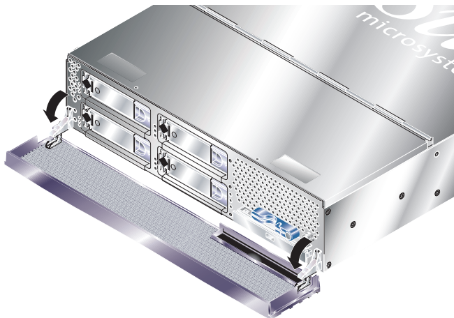
ABBILDUNG 2-2 Öffnen der Frontblende beim Sun Fire V240
