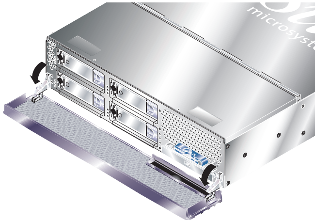
FIGURE 2-2 Ouverture du chanfrein du serveur Sun Fire V240
