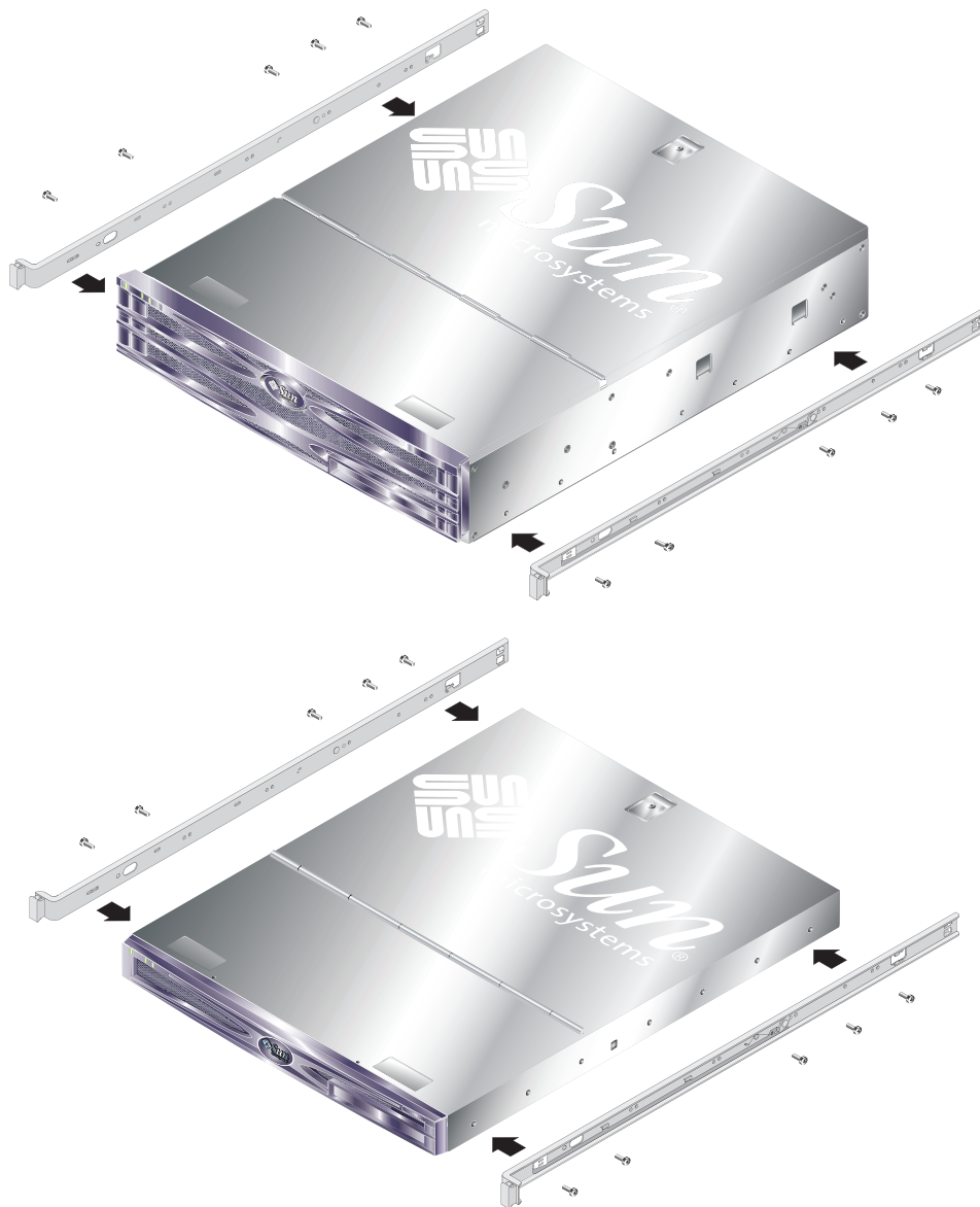
РИС. 2-2 Крепление внутренних скользящих планок к корпусу сервера
