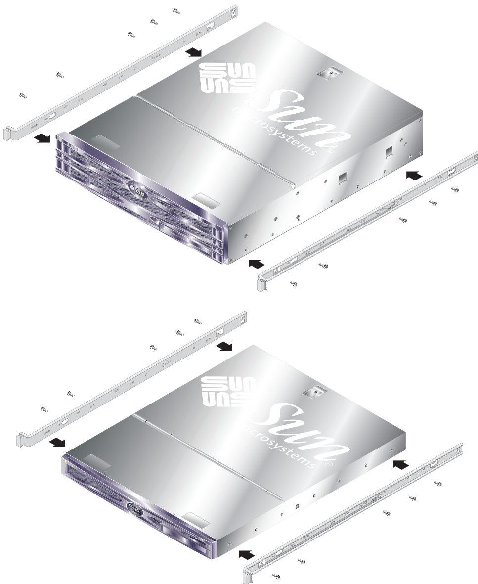
FIGURA 2-2 Fissaggio delle guide interne al server
