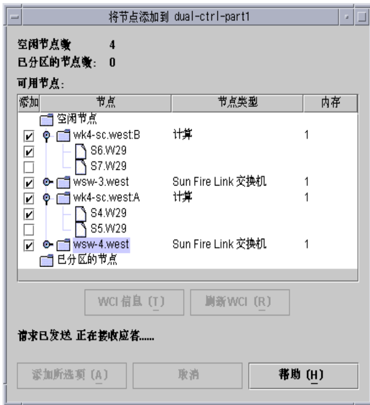
图 6-10 将选定节点和交换机添加到 Sun Fire 6800 系统的双控制器分区的“添加节点”对话框
