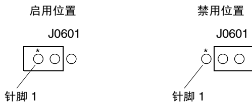
图 1-4 交换机系统控制器模块上的写闪存启用跳线
