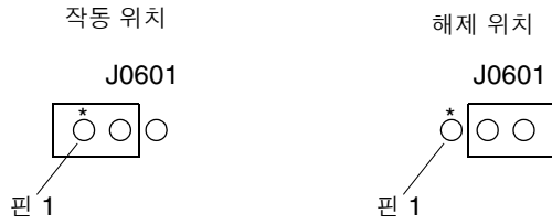
그림 1-4 스위치 시스템 컨트롤러 모듈의 플래시 쓰기 작동 점퍼
