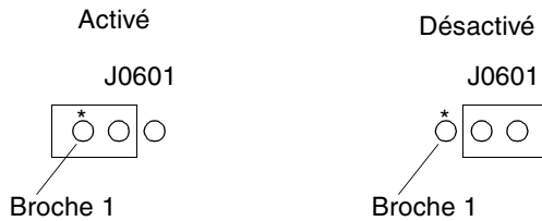
FIGURE 1-4 Cavalier d'activation d'écriture flash sur le module Contrôleur système
