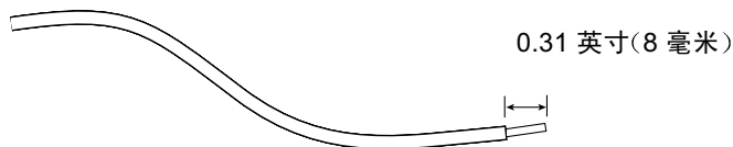
图 3-2 剥离导线的绝缘材料
