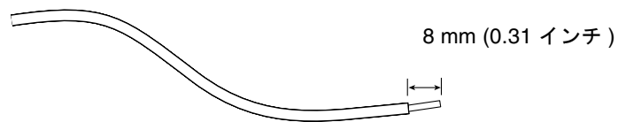
図 3-2 配線からの絶縁被膜の除去
