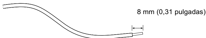
FIGURA 3-2 Cortado del aislante del cable
