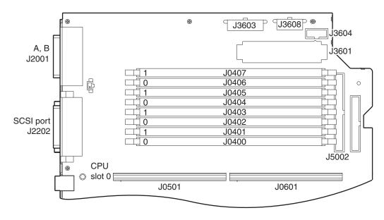
FIGURE 10-6 DIMM Mapping
