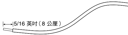
圖 5-47 剝去電線絕緣層
