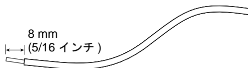
図 5-47 線から絶縁を剥がす
