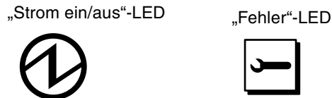
ABBILDUNG 2-2 „Strom ein/aus“- und „Fehler“-LEDs
