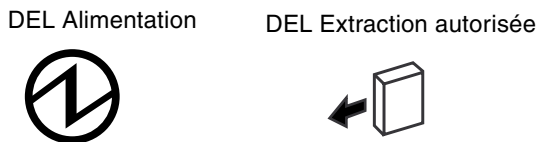
FIGURE 2-1 DEL Alimentation et Extraction autorisée
